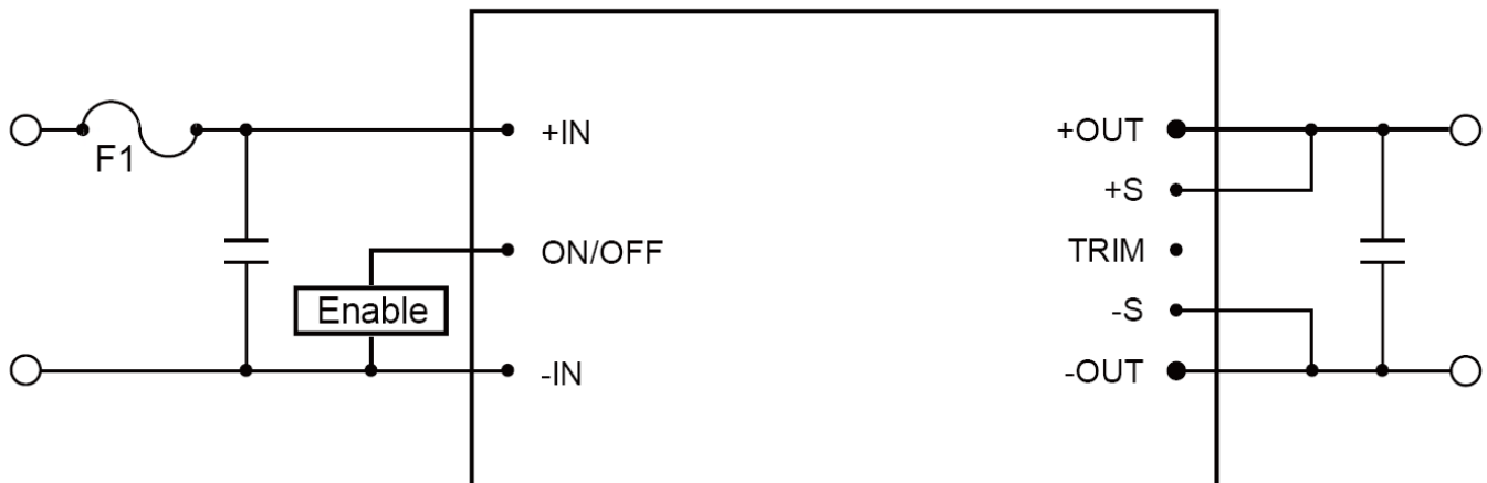
图1, 模块运行需要保险丝, 输入电容, Enable控制
