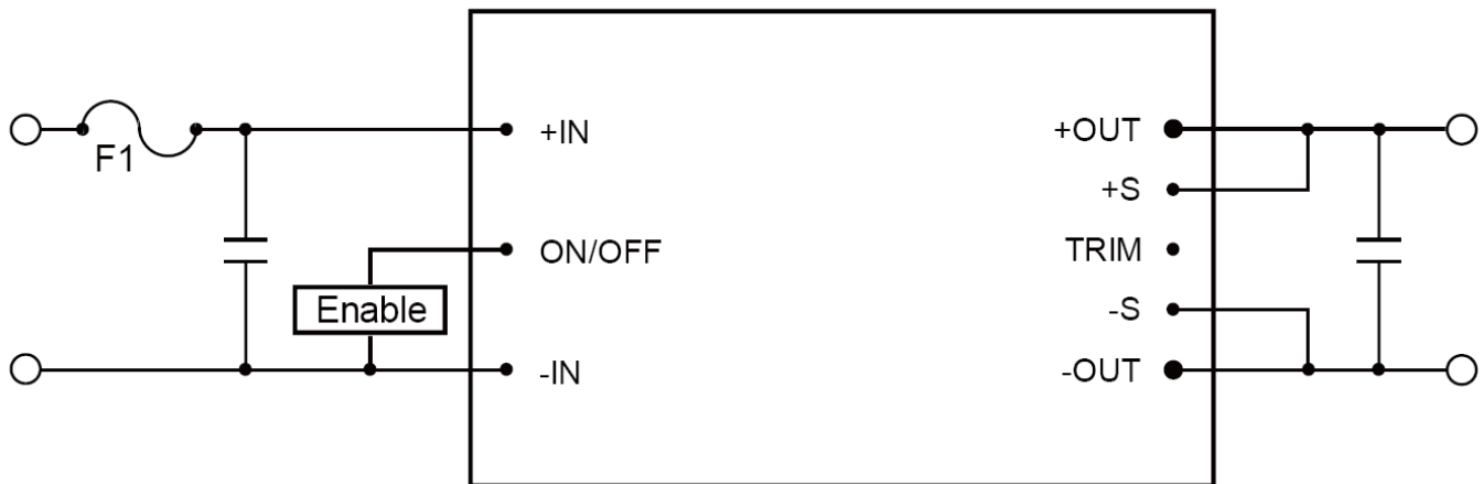
图1，模块运行需要输入电容，Enable控制（负逻辑），建议接入保险丝
