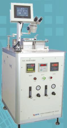
真空可控气氛共晶炉
