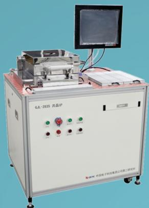
真空可控气氛共晶炉
