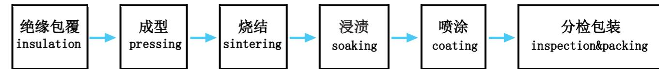
绝缘包覆工序是通过化学和物理方法在每个金属粉末表面包覆一层膜，提高粉末表面的电阻率和粘接性；成型工序是将绝缘包覆好的粉末压制成各种形状的磁心；烧结工序是将压制好的磁心在一定温度下进行热处理，释放应力，提高磁心的机械强度，达到一定要求的电磁特性；浸渍工序是将烧结后的磁心浸泡在树脂溶液中，然后在一定温度下固化，以进一步提高磁心的机械强度；喷涂工序是在烧结好的磁心表面涂覆一层树脂，以提高磁心的表面电阻；分检包装工序是对喷涂后的磁心进行外观检验，将合格品喷码、包装后入库。
