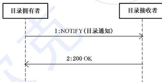
图 26 目录通知流程示意图
