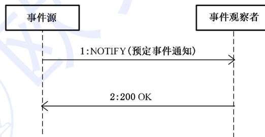
图 24 事件通知流程示意图
