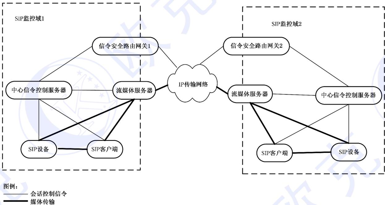
图 1 SIP 监控域互联结构示意图
