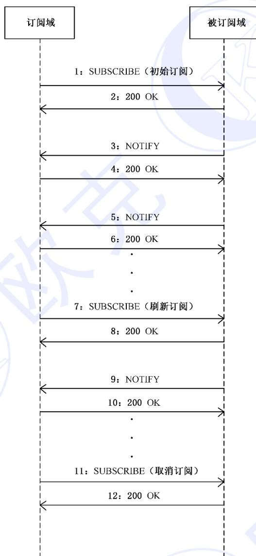
图 P.3 订阅通知信令流程示意图
