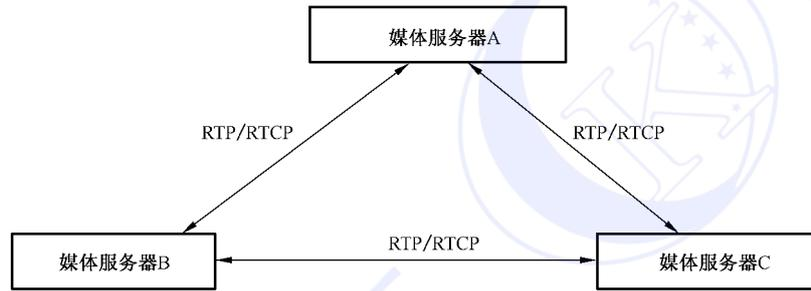
图 5 媒体互联结构示意图
