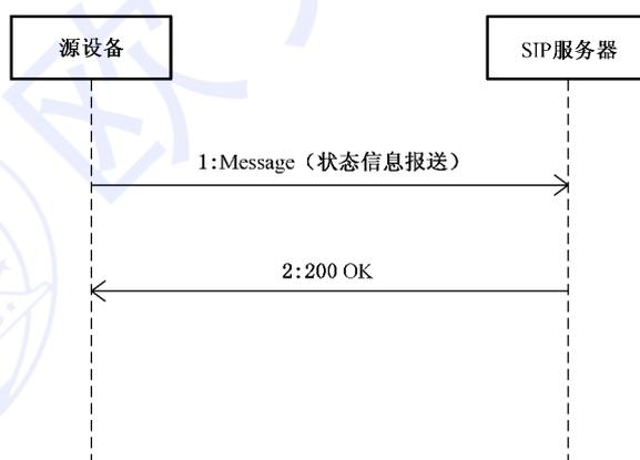
图 17 状态信息报送流程示意图
