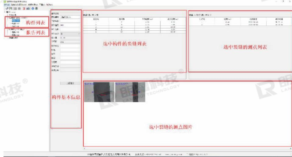
在测点列表区单击选中任意一个测点，如下图所示，测点图片区将以蓝色边框形式自动选中该测点的图片；双击图片可放大查看。
