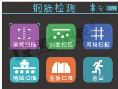
图3.2 钢筋检测主界面
