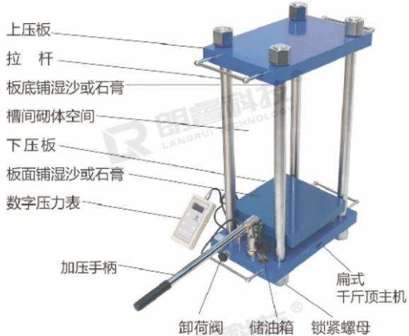
图1 LRYW-80T砌体原位压力机工作状态示意图
