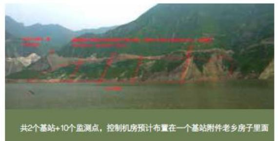
图2-2 火石子滑坡布点图
