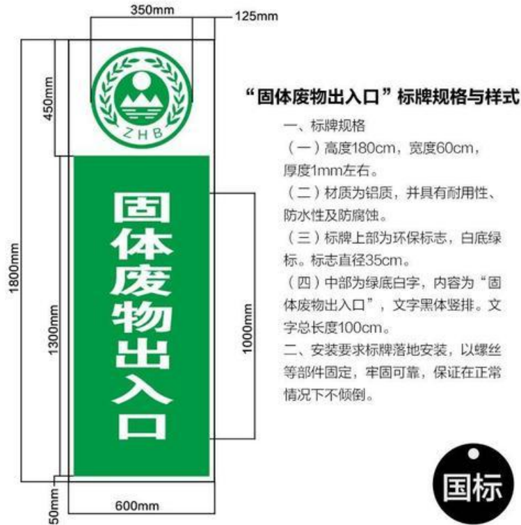
图 7.3-6 固体废物出入口规格样式
