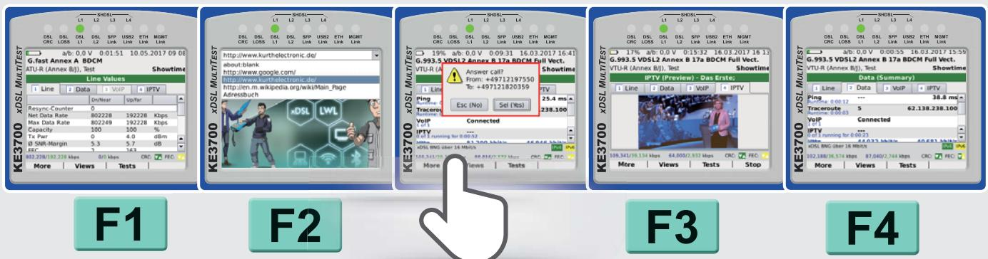
传统的测量仪器在切换两个测试任务或菜单功能的时候需要等待一段延迟时间。xDSL综合测试仪可以通过快捷键或键盘快速切换两个并行的任务，就像一台PC那样，是真正的多任务系统，可以在不同的窗口之间滚动操作。通过PPP(点到点协议)连接，不会丢失当前同步的网络，并可以增加新测试项目。快速、操作便利、综合性强的测试仪由此确立。
