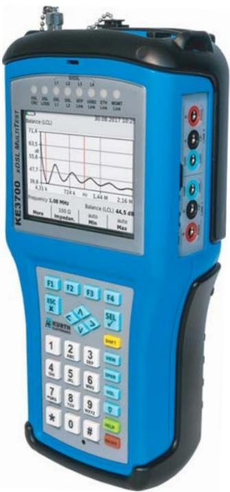
KE3700 CT电信线路鉴定仪有数字万用表功能，用于AC或DC范围内的故障分析；TDR功能可用于电缆故障定位；测量远端信号网络至31MHz。
