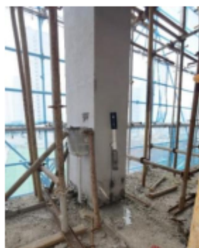
图 3 负压充浆试验
