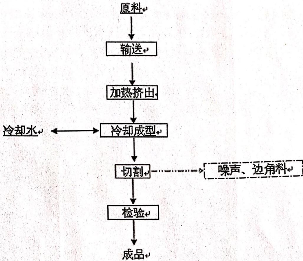
图 3.2 PVC/PE 管生产工艺流程图
