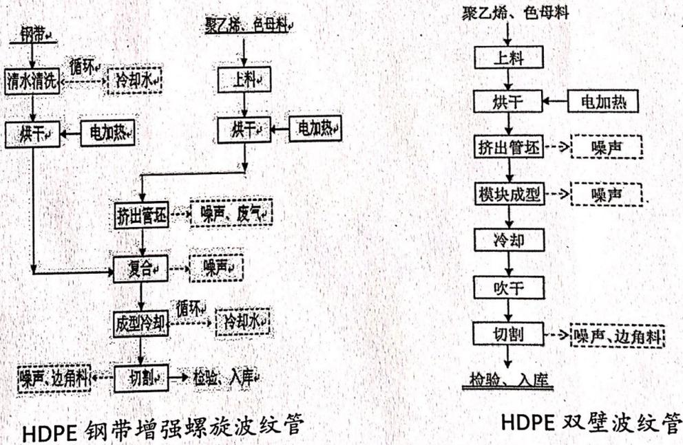
图 3.3 钢塑复合管生产工艺流程图
