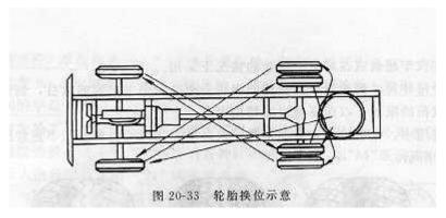
不同规格或不同帘线结构的轮胎不得混合使用,不得使用低于规定层级的轮胎,不许 混用窄轮辋或窄轮胎。
