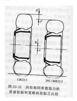
由于宽断面轮胎具有断面宽、接地面积大、接地比压小、磨损小、滚动阻力低以及抗侧滑能力强等优点,在相同的承载能力下,其直径可以减小。如图 20—31 所示,扁平率为 80%的宽断面轮胎,车轮中心下降了 B、A 之差,从而降低了整车重心,提高了汽车的行驶稳定性,因而在高速轿车上得到广泛采用。
