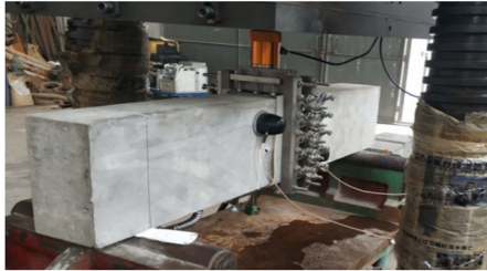
图 5 混凝土梁水力劈裂试验
