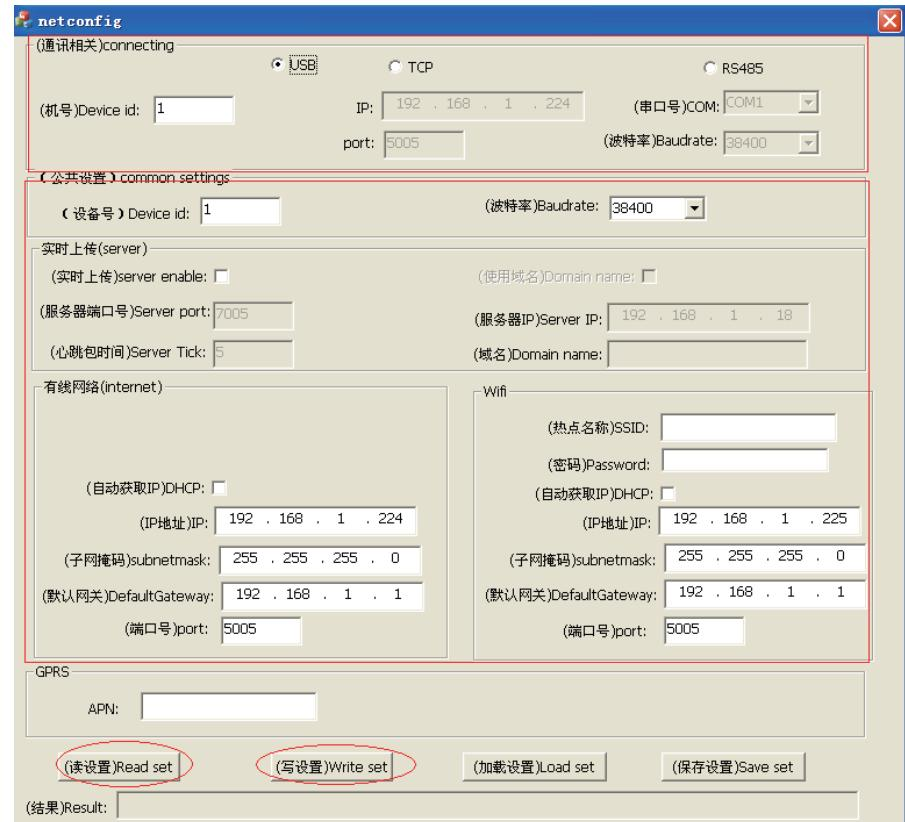
2:点 **(读设置)Read set** < (读设置) Read set>, 获取控制板的设置信息
