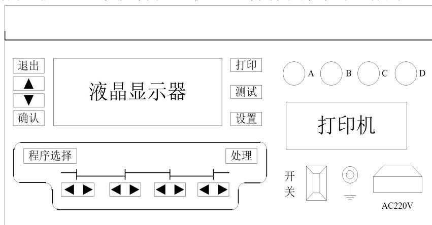
1. 打印机：本仪器采面板式前换纸SP-H4015PK型微型高速打印机，保证输
