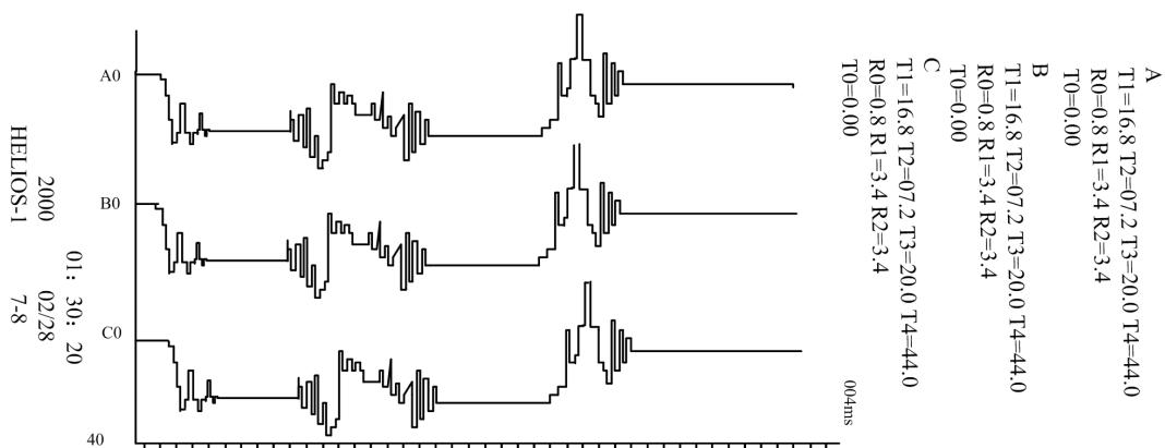
图中所示波形纵坐标刻度表示电阻值,我们可以看出该开关动作前测试线等引起的零点电阻为0.8欧姆左右,而开关动作A相接入R1的电阻值为2.5欧,接入R2的电阻约为2.5欧左右。
