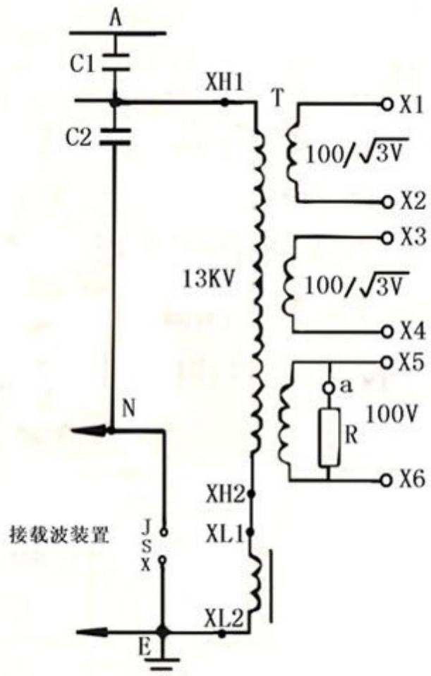
图15 CVT结构原理示意图
