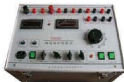
主要用途: 本机可测试各种交直流、电流、电压、中间、自保持、信号等多种单个继电器及整组继电保护屏。
