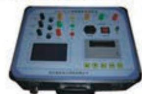
▶ **主要用途:** 该仪器用于测量工频线路正序阻抗、零序阻抗、正序电容、零序电容、两条线路的零序互感阻抗、零序互感电容的测量。
