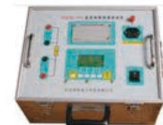
▶ **主要用途:** 本仪器专门快速测量变压器、电机、互感器感性设备的直流电阻。
