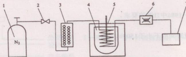
1—气瓶; 2—减压阀; 3—干燥器; 4—水渗透管动态配气装置(外渗式);
