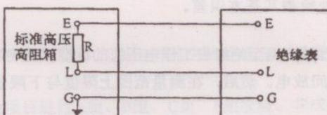
R—标准电阻；E—接地端子；L—测量线路端子；G—屏蔽端子
