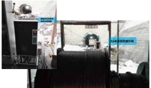
CV3100变频器在打桩机上的应用
