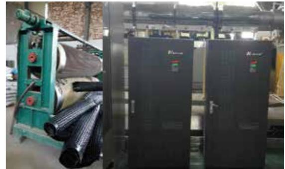
CV3100变频器在卧式螺旋离心机上的应用
