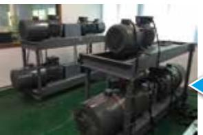
电机性能对拖测试平台
