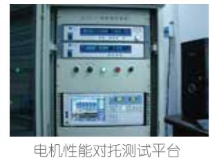
电机性能对拖测试平台
