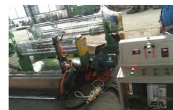
CV3100变频器485通讯在造纸设备上的应用
