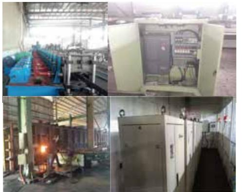
变频器在多级直进式拉丝机上的应用
