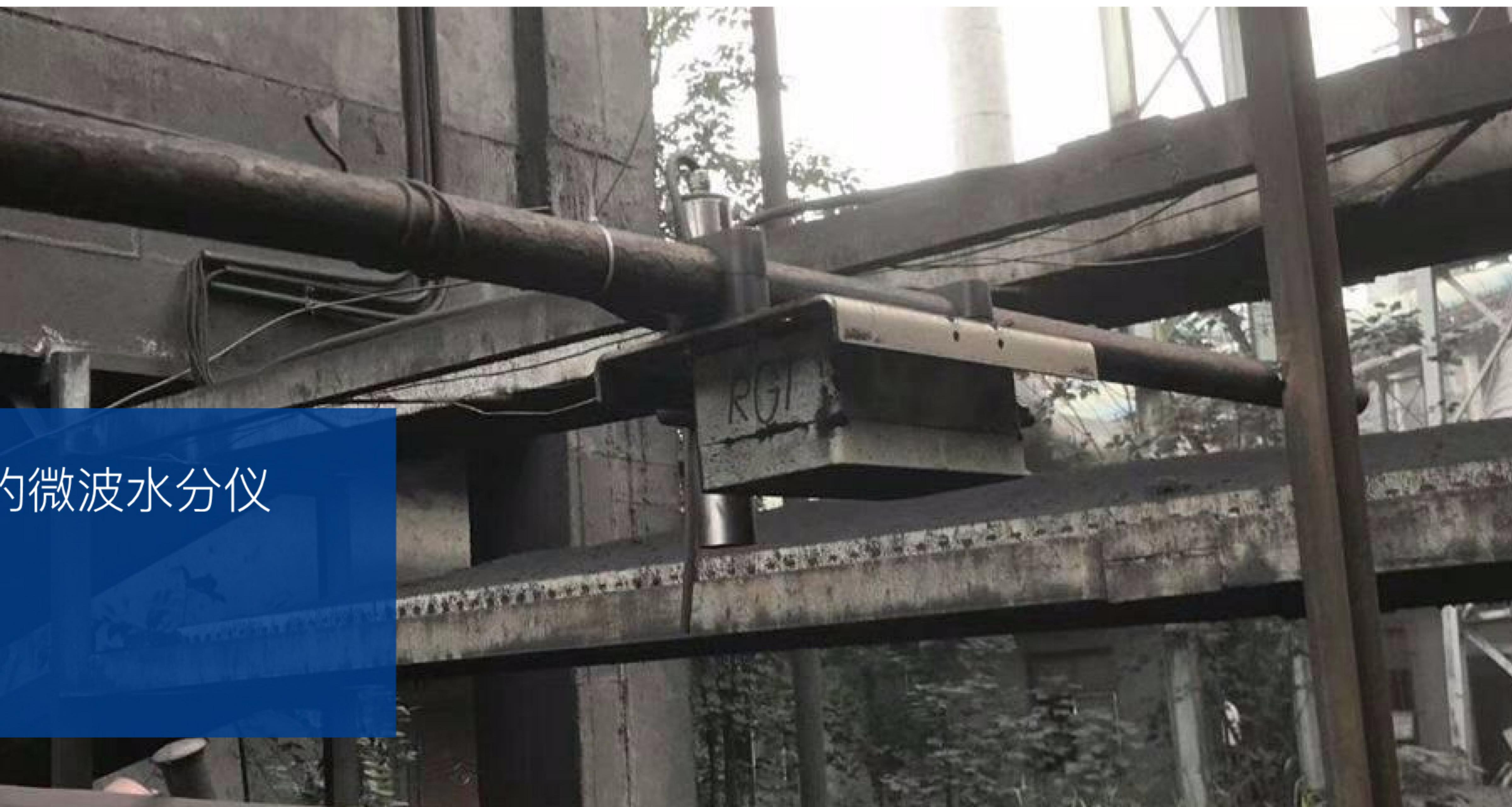
RGI安装于奥地利某钢铁厂的微波水分仪
