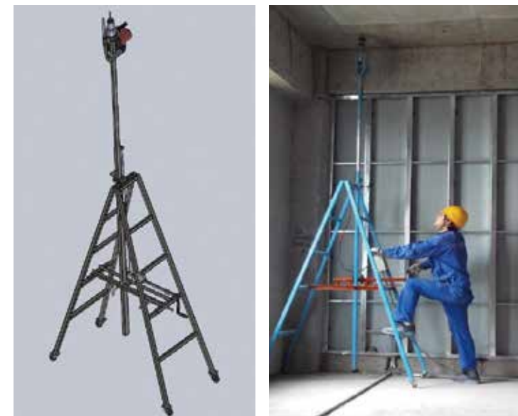
天花打孔机：使用过程中，方便移动、升降，效率可达传统机器的4倍左右。
