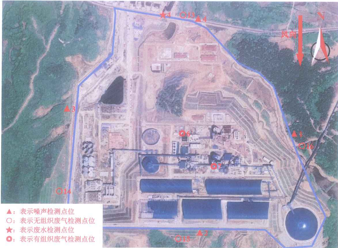
附图 1 江西万年青水泥股份有限公司万年水泥厂 2022 年度第二季度自行监测（新厂区）点位图
