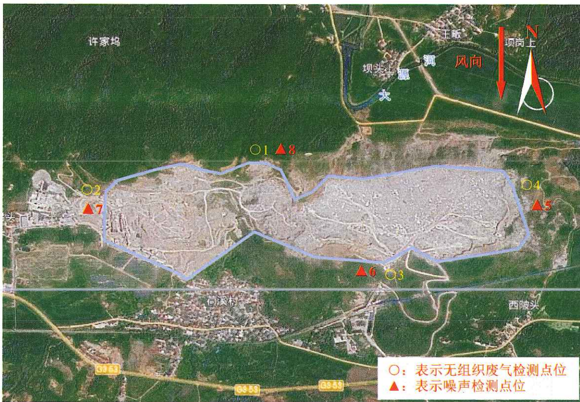
附图2 江西万年青水泥股份有限公司万年水泥厂2023年度第三季度自行监测点位图(石灰石矿区)
