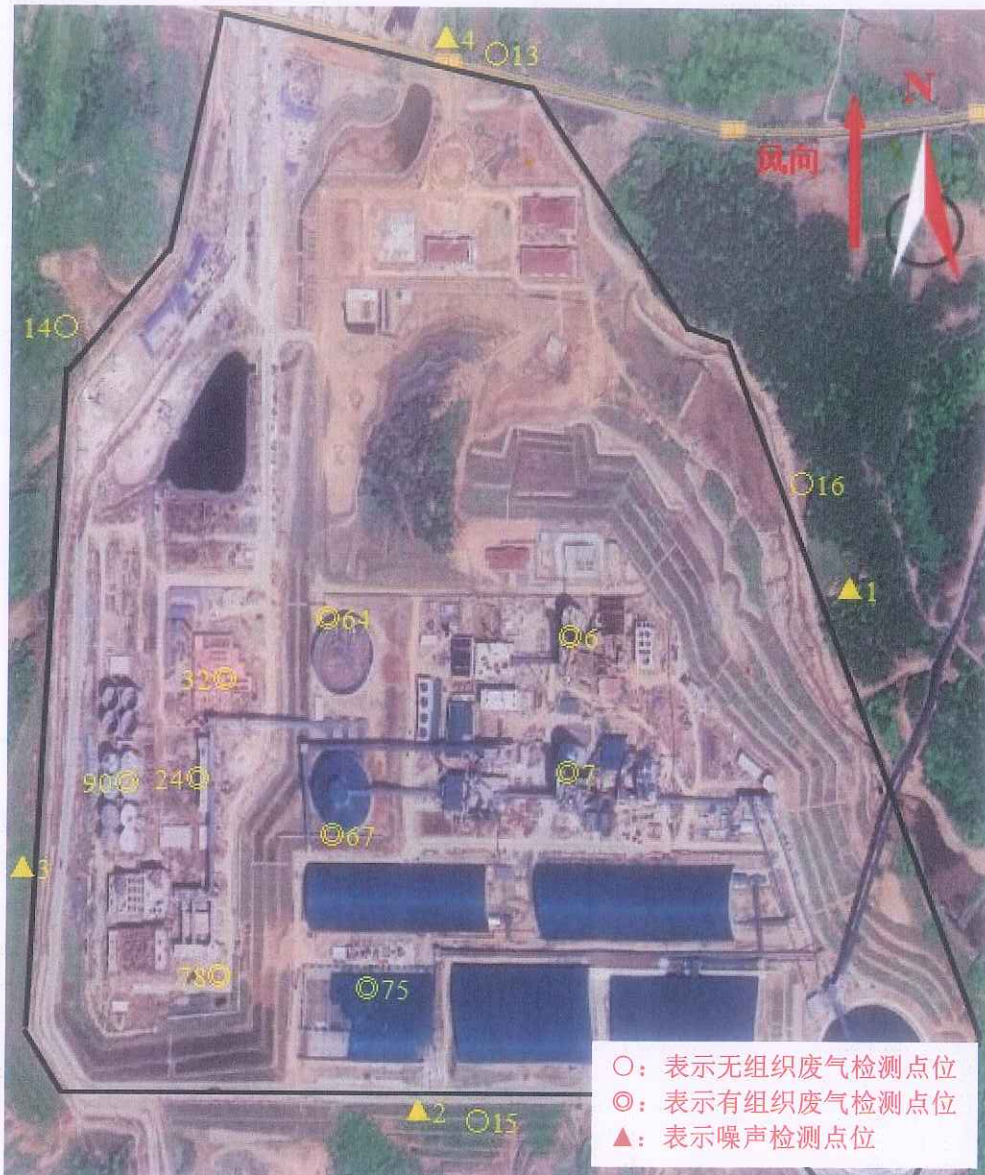
附图 1 江西万年青水泥股份有限公司万年水泥厂 2023 年度第四季度自行监测点位图（新厂厂区）
