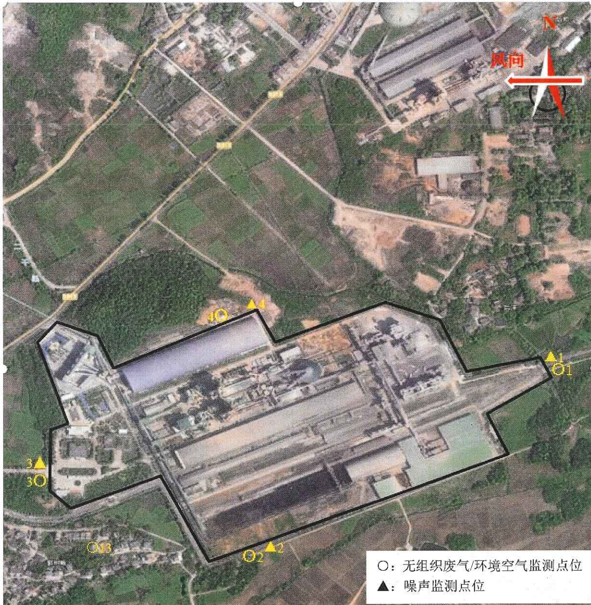
附图二 江西玉山万年青水泥有限公司 2023 年第二季度环境自行监测检测点位示意图 (生产厂区)
