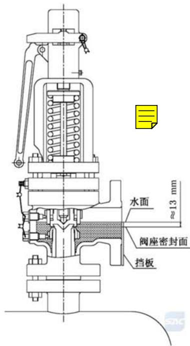
图3 开放式阀盖安全阀阀座气密封试验
