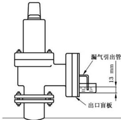
图2 封闭式阀盖安全阀阀座气密封试验
