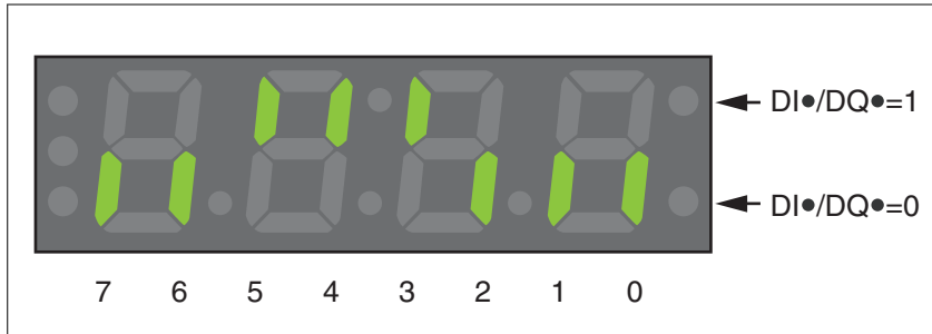
图 40: 集成 HMI，显示数字量输入 (DI) 和输出 (DQ) 的信号状态
