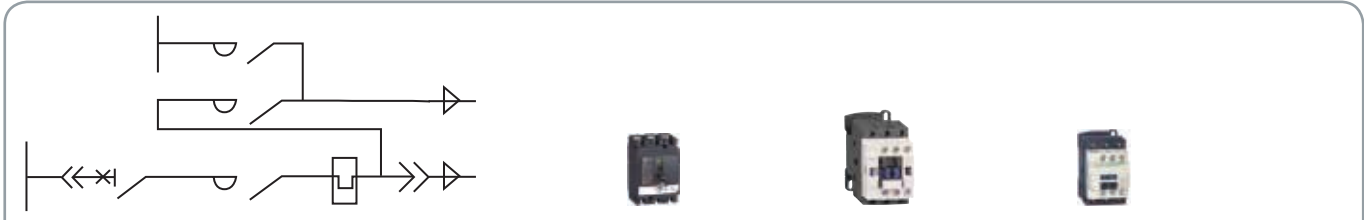
70-2型 MCC 马达控制抽屉 400/415V 配合类型二 Star-delta星三角 IP31 35°C
