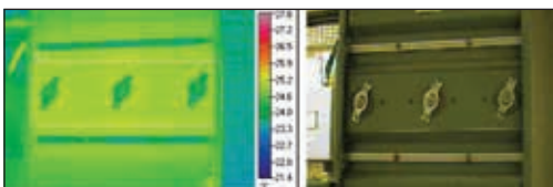
不同电流等级母线满载运行时的温度
