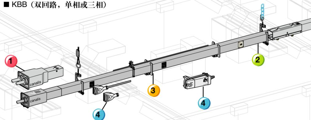
① 馈电单元 ② 直身段 ③ 固定装置 ④ 支撑单元
