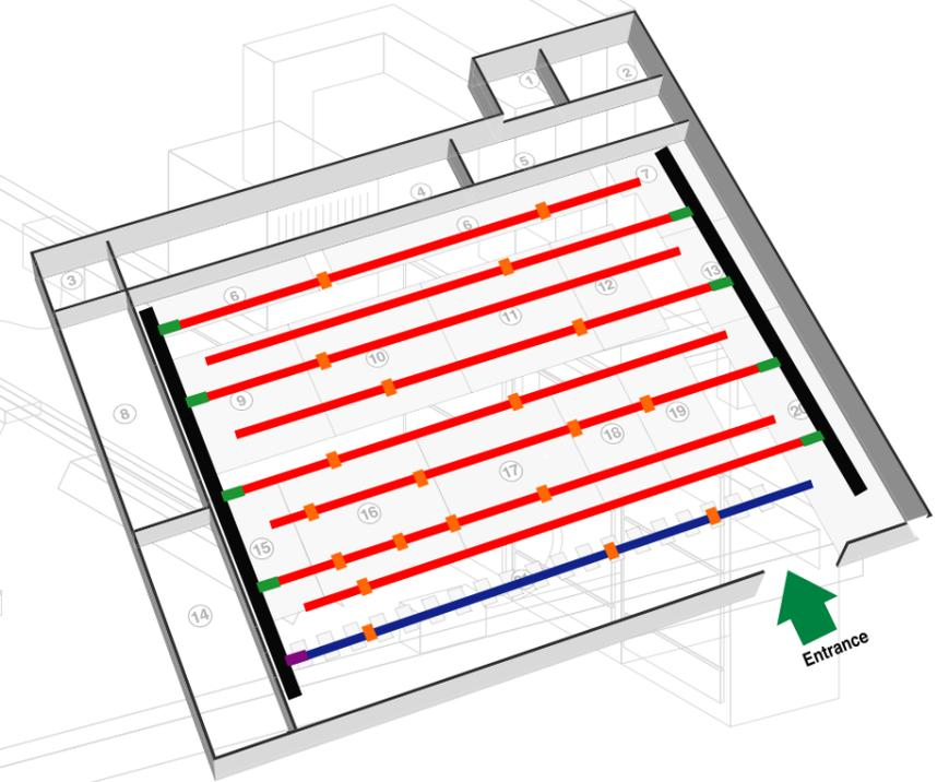
说明：照明回路使用KSA25EA403S3（标准长度为3米的25A KB三相母线）收款柜台区域使用KBB40EA423S3（标准长度为3米的40A KBB三相加单相母线，其两条独立回路分别为收款区域的电脑系统和照明回路配电）；应急照明可以使用KBA，在母线上用电缆夹固定一单独电缆回路为其配电（也可使用KBB，用其一条回路单独为应急照明配电）；照明母线间距为3米（同等照明面积下的母线间距取决于所需照度、光源、墙壁和地板反射率等），灯具直接悬挂在照明母线槽上；两条250A KS分别在两侧为50%的照明回路配电（亦可在每侧使用两条100A KN 作配电干线）。
