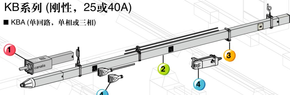
① 馈电单元 ② 直身段 ③ 固定装置 ④ 支撑单元
