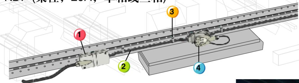
① 馈电单元 ② 直身段 ③ 固定装置 ④ 支撑单元
