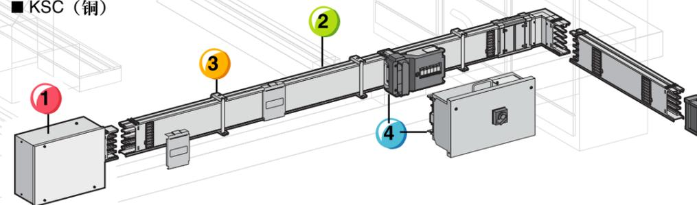
① 馈电单元 ② 直身段 ③ 固定装置 ④ 支撑单元
