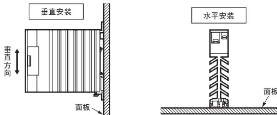
注：水平安装时，请在额定负载电流为50%的状态下使用。紧密安装时，请参见特性数据中紧密安装型的相关数据。
