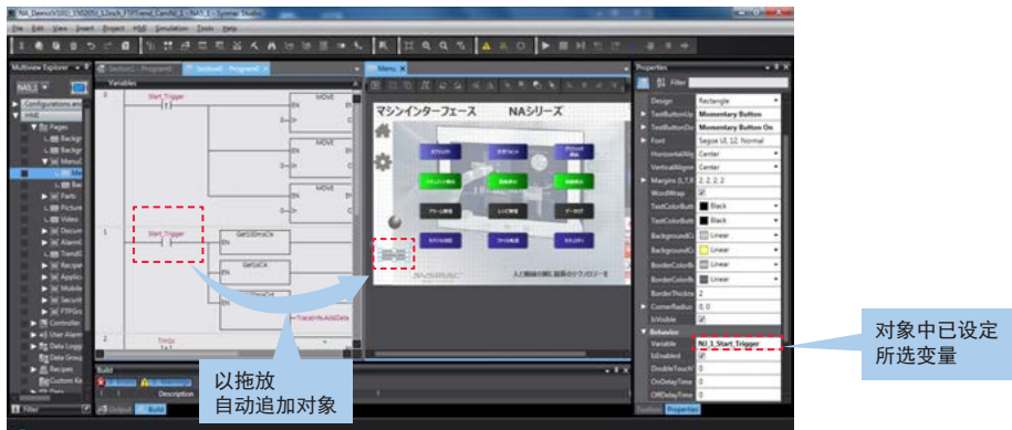
* 指定输入接点时自动创建按钮，指定输出接点时自动创建指示灯。
