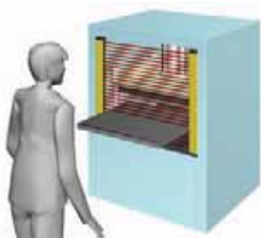
适用于检测区域内遮光物体 为固定的场合
