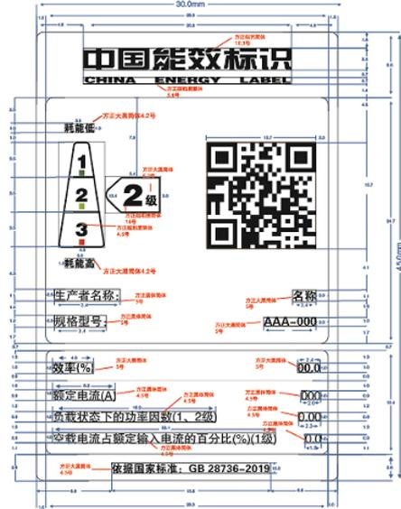
图 1 电弧焊机能源效率标识样式示例 (标准)
