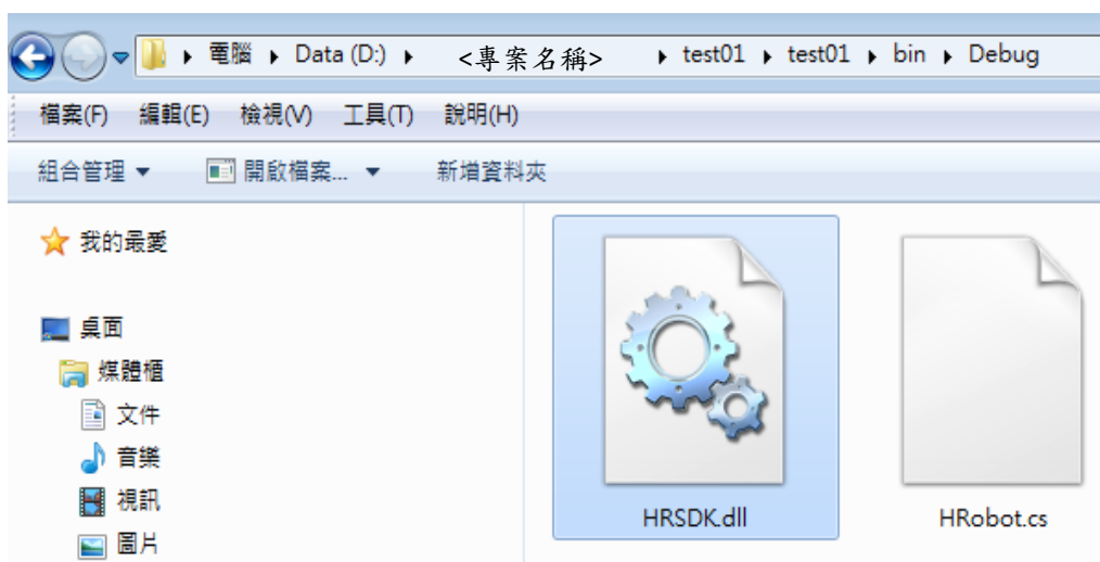
圖 2-4 複製 HRSDK.dll & HRobot.cs 檔案至指定資料夾圖
