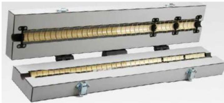
根据 IEC61000-4-6 标准的电磁去耦钳
