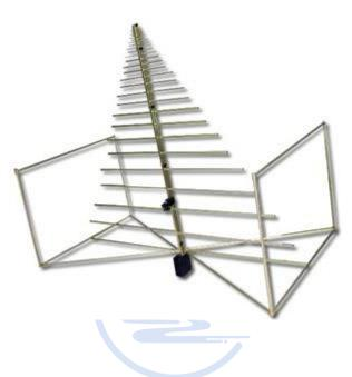
SAS-522-5 宽带混合天线组件是一种紧凑型组装天线,其频率范围 25MHz-5GHz,适用于户内/户外多种测试环境。天线的平衡块采用的不平衡~平衡转换器,在 EMC 测试中非常适用。
