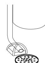
※连接进水管前，清除管路中残留杂质、灰尘等污物。将进水总阀门关闭后连接本设备。
