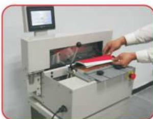
将纸靠紧右端后夹紧，踩下开关，裁掉第一部分。
