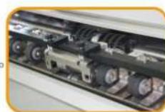
气吸式自动送纸，快速平稳，防止印刷面造成刮痕。
