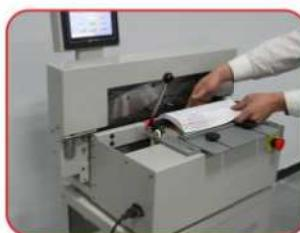
自动移动进入第二个位置，将已切好的部分压到机器间隙处。
