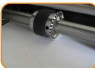
打孔(压针孔、米线)
