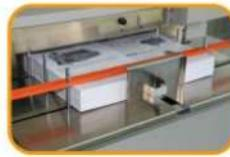
PLC程控设定压痕位置，压痕组件自动移动。
