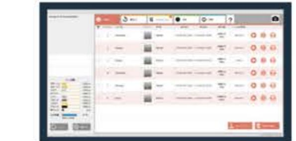
可在打印机本体的面板上进行操作。能对应启动输出、确认打印履历、检测喷嘴状态及清洗。
