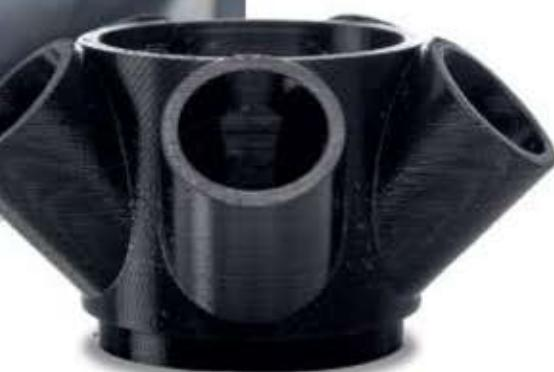
由于CPE+具有极其卓越的韧性和抗化学性，所以它是打印功能性原型和机械部件时的首选材料。相比常规CPE(达100 °C)，其具有较高的抗冲击强度和耐高温性，表现出良好的尺寸稳定性。
