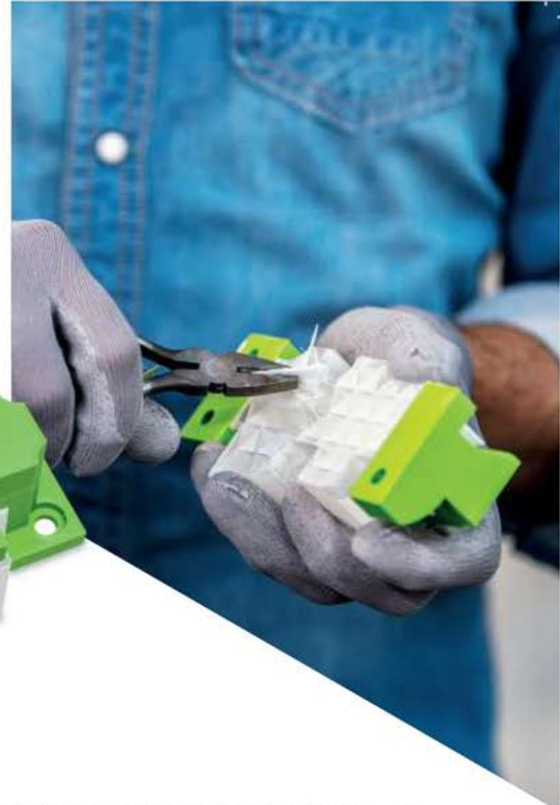
Ultimaker Breakaway是一种用于多喷头3D打印的支撑材料。它能够迅速被移除，无需进一步加工处理：只需将支撑部分剥离，即可得到尺寸精确而贴合设计的部件。Breakaway与ABS、尼龙、PLA、Tough PLA、CPE或CPE+具有良好的粘合性，为您创造出一种无后顾之忧的3D打印体验。
