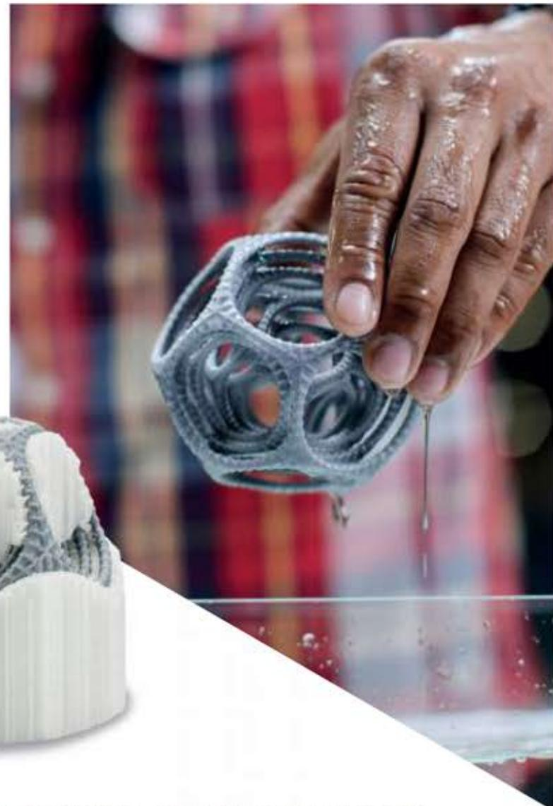
Ultimaker PVA（聚乙烯醇）是一款水溶性支撑材料，用于多层喷头式3D打印。它拥有较好的热稳定性，非常适合打印有大范围的悬空支撑、深内腔或精细几何图形的复杂模型。它与PLA、Tough PLA、CPE以及尼龙都具有良好的粘合性，从而使其用途广泛。
