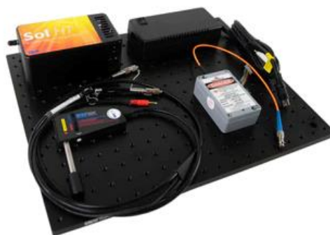
图 2 基于模块的拉曼系统，包括激光器、含探测器的光谱仪和光纤采样探头。
