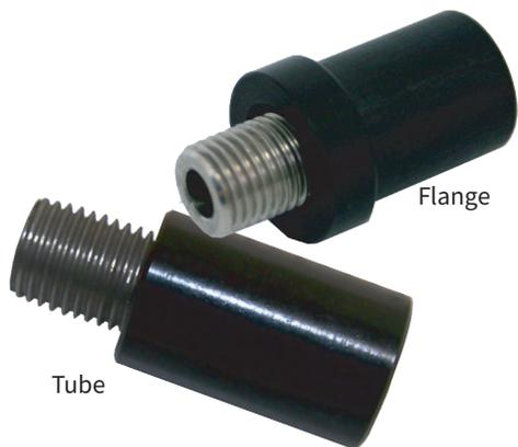
CLA-SMA 准直镜可将发散光平行输出。内置的透镜材料为熔融石英, 适合宽光谱范围, 包含紫外/可见/近红外波段的应用。CLA-SMA 可与 B&W Tek 光纤跳线和光纤组件上的 SMA 905 连接器连接。当与光纤跳线连接至光源时, CLA-SMA 可输出平行(准直)光。当与光纤跳线连接至光谱仪时, CLA-SMA 可提供较小的接收角和狭窄的视场。
