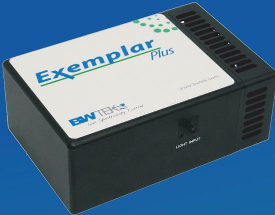
Exemplar® Plus (BTC655N) 是一款高性能的智能光谱仪, 采用了低杂散光的非交叉型 Czerny-Turner。配备高灵敏度, 高灵敏度的薄型背照式 (BT) CCD 探测器。通过较长的焦距和高量子效率的探测器相结合, 可在整个 190nm-1100nm 的光谱范围内提供优秀的的数据质量。Exemplar® Plus 具有较高的信噪比, 是弱光条件下应用的理想选择。其内置一个快门, 可在光照环境下获得高质量的暗光谱。
