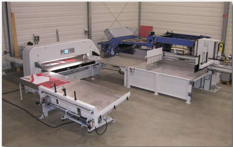
E-Line 260 裁切生产线：两个大型的传输操作台、闯纸机和堆垛机
