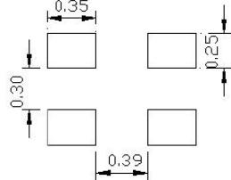
说明：所有尺寸公差:  $x.x \pm 0.1\text{mm}$ 、 $x.xx \pm 0.05\text{mm}$ (长边引脚间距 $\pm 0.1\text{mm}$ ) Note:
