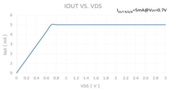
Fig. I<sub>out</sub> 与 OUT/R/G/B 端口电压 V<sub>DS</sub> 的关系图
