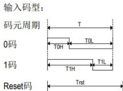
Fig. 归零码数据通信协议图
